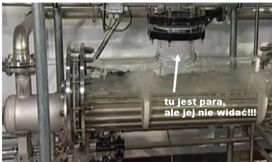
Rysunek 1. Wytwornica pary w czasie produkcji pary – wytwarzanej pary nie widać!
