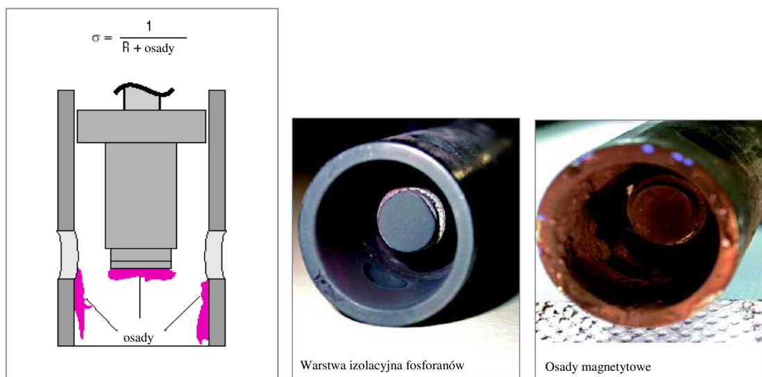
Rys 5. Wpływ powłok i osadów na powierzchniach pomiarowych elektrody pomiaru przewodności na zaniżanie wartości pomiaru
