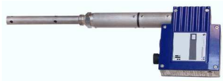
Rys. 4 LRGT16-1 elektroda pomiaru przewodności z automatyczną kompensacją temperatury – system dwuelektrodowy
