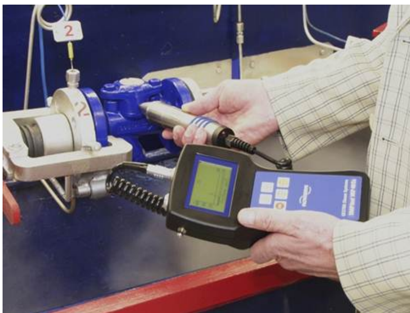
Rys.2 Pomiar poprawności działania odwadniacza metodą ultradźwiękową
